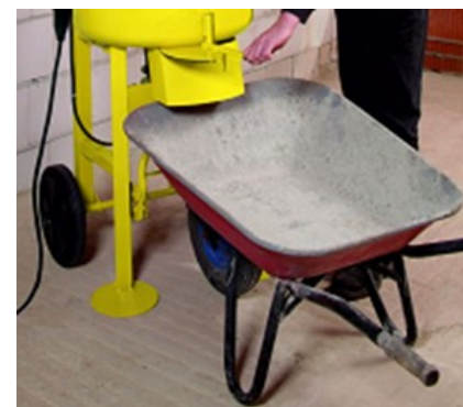
Directe lediging in een kruiwagen door de hoogte van de afvoergoot
