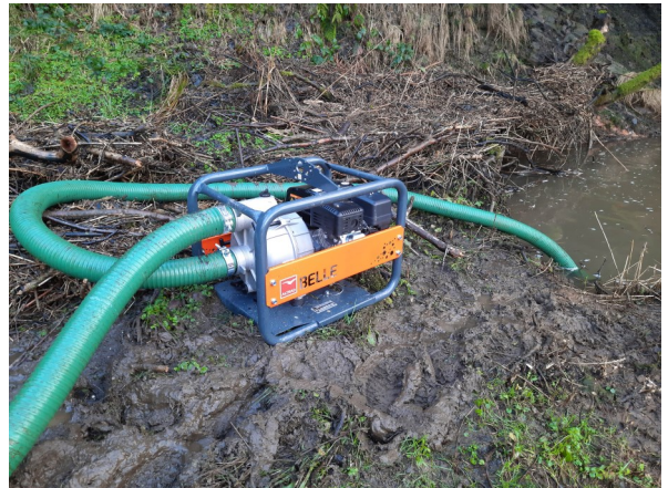
Robuust frame ter bescherming, afneembaar voor onderhoud en voorzien van hijs oog.
