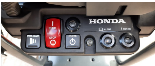
Simpele bediening met 1 schakelaar voor start en selectie van 3 snelheden.
