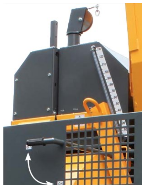
Grote capaciteit watertank met niveau-indicator en bedieningshendel
