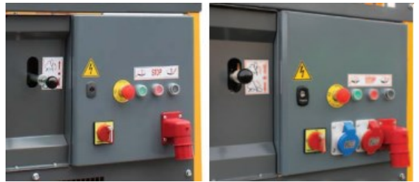
Bedieningspaneel: links elektrisch / rechts diesel met output van ingebouwd stroomaggregaat
